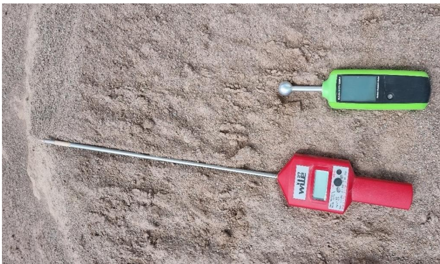
Figur 3. Underst i bilden är den röda WILE-mätaren och över den gröna Elma DT-128 fuktmätaren.
