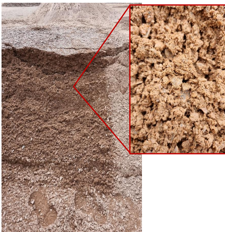
Figur 8. Genomskärning av upplag 0/16 i täkt 2 efter att mätning på vått material genomförts. Ytan har hunnit bli torr innan genomgrävningen gjordes av lastmaskin.
